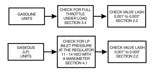
PROBLEM 7 - GENERATOR CIRCUIT BREAKER TRIPS / NO AC VOLTAGE
